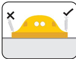
Coloque el clavo en el ojillo correspondiente para evitar perforaciones extras de 1/4" X 3." / Place the grooving bolt into the hole of the round road marker, avoiding extra perforations.
