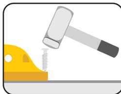
Para una sujeción excelente coloque 4 clavos de 1/4 X 3."
